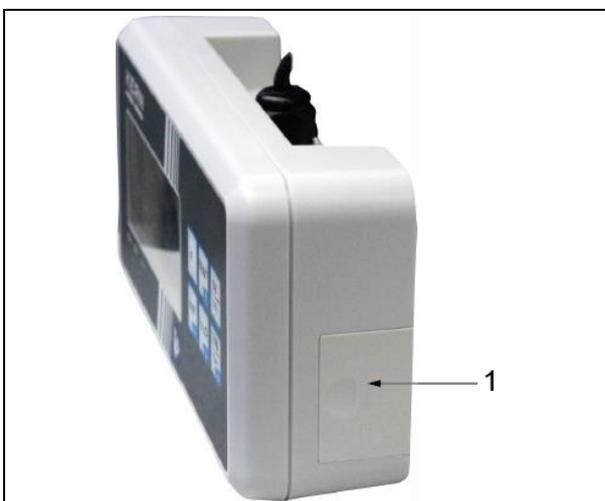
Akkufachdeckel (1) an der Unterseite des Anzeigegerätes öffnen und Akku anschließen. Der Akku sollte vor der ersten Benutzung mindestens 12 Stunden geladen werden.
