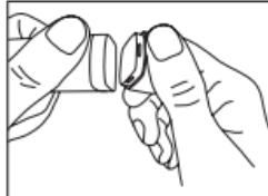
Sostituire le due batterie scariche (2 x LR44 1,5 V) con batterie nuove. Osservare la polarità delle batterie; il polo positivo di entrambe le batterie deve essere rivolto verso l'esterno.
