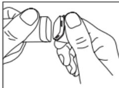
Substitua ambas as pilhas gastas (2 x LR44 1,5 V) por novas. Respeite a polaridade das pilhas; o polo positivo de ambas as pilhas deve estar voltado para fora.
