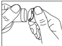
Sustituya las dos baterías vacías (2 x LR44 1,5 V) por otras nuevas. Tenga en cuenta la polaridad de las baterías; el polo positivo de ambas baterías debe estar orientado hacia el exterior.
