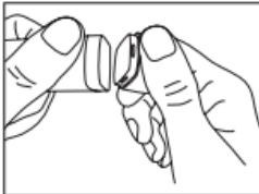
Skift de to brugte batterier (2 x LR44 1,5 V) ud med nye. Sørg for at placere polerne på de to batterier korrekt: Pluspolen på begge batterier skal vende udad.
