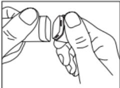
Ersetzen Sie die beiden leeren Batterien (2 x LR44 1,5 V) durch neue. Beachten Sie die Polung der Batterien; der Pluspol beider Batterien muss nach außen weisen.
