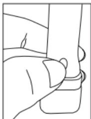
Hold inn lysbryteren og se gjennom linsen inn i apparatet for å se testresultatet. Se grundig på prøven for å kunne se resultatet optimalt. Unngå omgivelser med sterkt lys.
