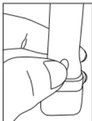
Kun valokytkin on painettuna, katso laitteeseen linssin läpi nähdäksesi testituloksen. Tutki näytettä tarkasti ja huolellisesti voidaksesi arvioida tulosta optimaalisti. Vältä ukopuolista kirkasta valoa.
