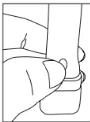
Con l'interruttore della luce premuto, guardare attraverso la lente del dispositivo per visualizzare il risultato del test. Osservare il campione da vicino e con attenzione per poter valutare il risultato in modo ottimale. Evitare la luce ambientale intensa.
