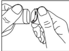
Byt ut de båda tomma batterierna (2 x LR44 1,5 V). Observera batteriernas poler, båda batteriernas pluspoler ska peka utåt.
