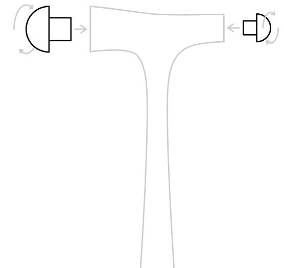
Meine Gummipuffer halten durch eine Schraubverbindung. Wenn du sie entfernen möchtest, drehe sie gegen den Uhrzeigersinn und ziehe sie vorsichtig heraus. Wenn du die Köpfe aufschrauben oder fester drehen möchtest, drehe sie mit Druck im Uhrzeigersinn. Bitte mach das mit viel Gefühl, damit die Puffer nicht abbrechen.
