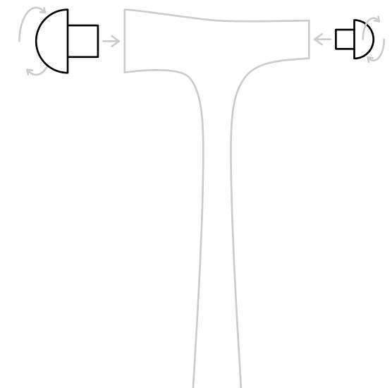
Mijn rubber buffers worden op hun plaats gehouden door een Schroefverbinding. Als u ze wilt verwijderen, draait u ze tegen de wijzers van de klok in en trekt u ze er voorzichtig uit. Als u de koppen wilt losdraaien of vaster wilt draaien, draait u ze met druk met de klok mee. Doe dit met veel gevoel, zodat de buffers niet afbreken.
