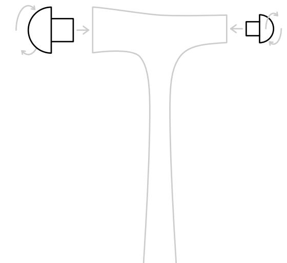
I miei tamponi di gomma sono tenuti in posizione da un collegamento a vite. Se volete rimuoverli, girateli in senso antiorario ed estraeteli con attenzione. Se volete svitare le teste o stringerle di più, giratele in senso orario facendo pressione. Per favore, fate lo con molta sensibilità in modo che i tamponi non si rompano.
