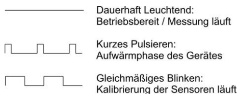
Abbildung 1: Mögliche Betriebszustände und deren LED-Signal
