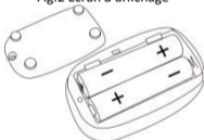
Fig. 3 Installation des piles
