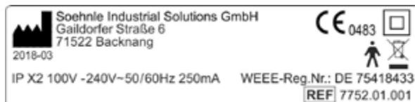
De afbeelding laat een voorbeeld zien van een typeplaatje op de schaalverdeling 7752.
