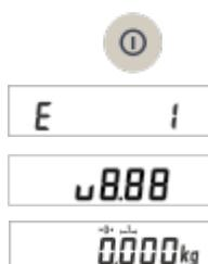
Drücken Sie bei unbelasteter Waage die EIN/AUS-Taste.
