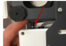
>Inserte el enchufe en el conector de alimentación del terminal.
