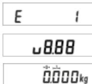
Después de que la rutina de prueba ha expirado, el contador de calibración y el estado de la versión se muestran brevemente y, a continuación, la pantalla cambia a cero.
