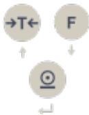
Viene visualizzato il numero dell'ultimo record di dati salvato. Con i tasti tara e funzione è possibile spostarsi all'interno dell'alibi memory e richiamare ogni record di dati con il tasto di stampa.
