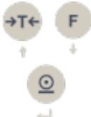
Mit der Tara-Taste im Menü schalten bis **UCL 5** erscheint und mit der Druck-Taste übernehmen. Anschließend mit der Tara-Taste bis zur Pos. **03** weiter-schalten und wieder mit der Druck-Taste übernehmen.
