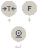
Appuyer sur la touche de tare dans le menu jusqu'à ce que UCAL 5 apparaisse et confirmer avec la touche d'impression. Utilisez ensuite la touche de tare pour passer en pos. 03 et confirmer avec la touche d'impression.
