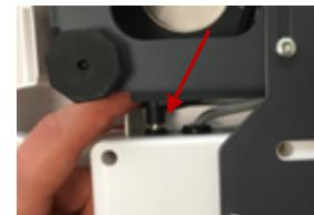
> Inserire la spina nel connettore di alimentazione del terminale.
