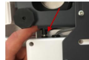
> Steek de stekker in de voedingsaansluiting van de terminal.
