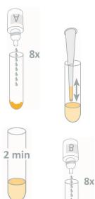
2. Trasferire la soluzione ottenuta, dalla centrifuga al tubo di estrazione. Lasciare riposare per 2 minuti.
