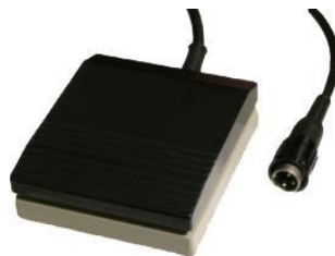
152-811-050 Fußschalter AP-geprüft, Kabellänge 5m, mit 3-poligem Stecker
