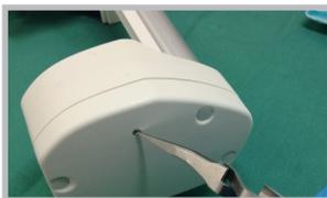
3. Débrayer le mécanisme des griffes.
