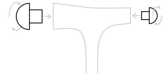
Mijn rubber buffers worden op hun plaats gehouden door een Schroefverbinding. Als u ze wilt verwijderen, draait u ze tegen de wijzers van de klok in en trekt u ze er voorzichtig uit. Als u de koppen wilt losdraaien of vaster wilt draaien, draait u ze met druk met de klok mee. Doe dit met veel gevoel, zodat de buffers niet afbreken.
