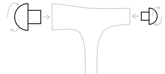
I miei tamponi di gomma sono tenuti in posizione da un collegamento a vite. Se volete rimuoverli, girateli in senso antiorario ed estraeteli con attenzione. Se volete svitare le teste o stringerle di più, giratele in senso orario facendo pressione. Per favore, fatelo con molta sensibilità in modo che i tamponi non si rompano.
