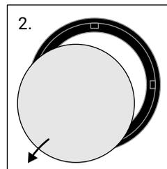
Retire l'ancienne membrane du bague de verrouillage.
