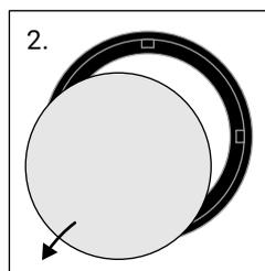
2. Rimuovi la vecchia membrana dall'anello di bloccaggio.
