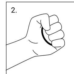
2. Neem een passende ring en druk deze een paar keer samen in de palm van je hand. De beweging en warmte maken de ring flexibeler en gemakkelijker te monteren.
