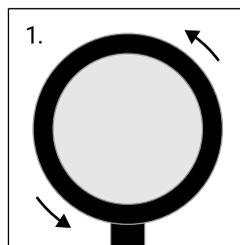
1. Allenta l'anello di chiusura dello stetoscopio ruotandolo in senso antiorario.
