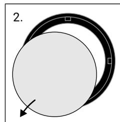
Retire la antigua membrana del anillo de fijación.
