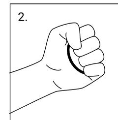
Coje un anillo adecuado y comprímelo un par de veces en la palma de la mano. Con el movimiento y el calor el anillo se vuelve más flexible, haciendo el montaje más fácil.
