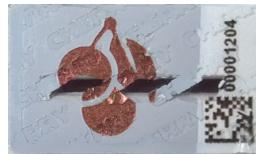
Am Slotsiegel kann eine Manipulation erkannt werden. In diesem Fall ist der Betrieb des Kartenterminals nicht mehr sicher.
