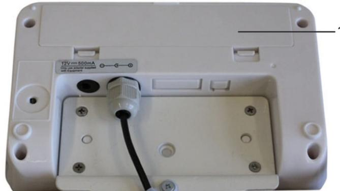
Akkufachdeckel (1) an der Unterseite des Anzeigerätes öffnen und Akkupack anschließen. Der Akku sollte vor der ersten Benutzung mindestens 12 Stunden geladen werden.
