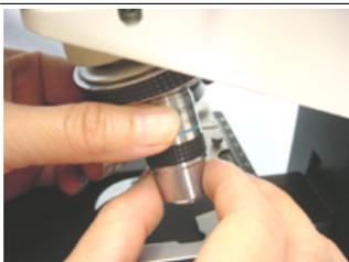
Nehmen Sie die Objektive vorsichtig aus dem Behälter heraus. Vorher die Deckel am Revolver abschrauben. Jetzt schrauben Sie die Objektive am Revolver fest. Dabei die Objektive immer mit einer anderen Hand halten, so daß sie nicht aus Versehen fallen können.
