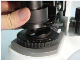
Einbau: Den unteren Keilteil genau auf die Keilschiene am Kondensorhalter stellen. Anderen Kondensor in die Fassung stellen. Den Kondensor vorsichtig jedoch mit etwas Kraft in horizontaler Ebene drehend ganz hineinschieben, bis nicht mehr geht. Danach die Befestigungsschraube auf der rechten Seite des Halters festschrauben.
