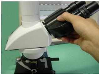
Packen Sie den Tubus vorsichtig aus. Halten Sie den Tubus immer mit der Hand fest, bevor dieser richtig am Mikroskop befestigt ist. Um den Tubus zu montieren, muss man den Tubus quer auf die Anbindungsstelle ansetzen wie die Abbildung zeigt, bis der Tubus richtig sitzt. Dann nach vorne vorsichtig drehen, bis der Tubus an der richtigen Stelle ist.
