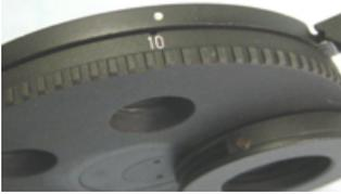
Die Vergrößerung des Objektivs muß immer mit der des Phasenkontrastringes übereinstimmen. Beispiel: Verwendet man das Objektiv 10-facher Vergrößerung, sollte man dementsprechend den Phasenkontrastring von 10 einsetzen, indem man die Drehscheibe am Phasenkontrastkondensator dreht, um den passenden Ring einzustellen.
