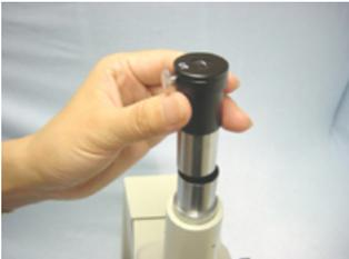
Stecken Sie das Okular mit der Bezeichnung „CT“ in den dritten Stutzen am Tubus. Schauen Sie in das Okular und überprüfen Sie, ob die beiden Ringe im Sichtfeld auf einander fallen.
