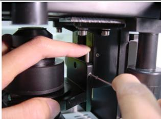
**Fehler:** Der Kondensor kann nicht dicht an Objektträger gefahren werden. Oder der Kondensor fährt unkontrolliert zu hoch, so dass der Objektträger gehoben wird.
