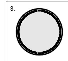
Lege eine neue Membran so in den Ring, dass sie flächig aufliegt.
