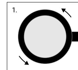
Déverrouille l'anneau en le tournant dans le sens inverse des aiguilles d'une montre.
