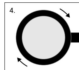
Enrosca firmemente el anillo de fijación en la campana para que queden bien colocados.
