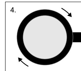
Draai de borgring met het het membraan stevig op het borststuk, zodat het goed aansluit.
