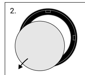
Entnimm die alte Membran aus dem Verschlussring.
