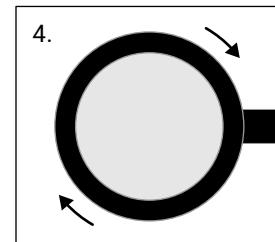
Drehe den Verschlussring samt Membran an das Bruststück, so dass diese fest anliegt.
