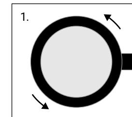
Löse den Ring, indem du ihn gegen die Uhrzeigerrichtung drehest.
