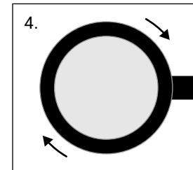
Ruota l'anello di chiusura e la membrana salda-mente alla testina per farlo aderire stabilmente.
