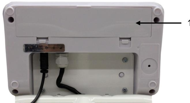
Akkufachdeckel (1) an der Unterseite des Anzeigegerätes öffnen und Akkupack anschließen.
