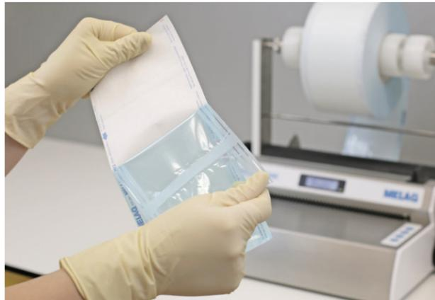
Veillez effectuer **tous les jours** un scellage d'essai avant de commencer à travailler. Le joint de scellage doit être régulier et complètement formé.
