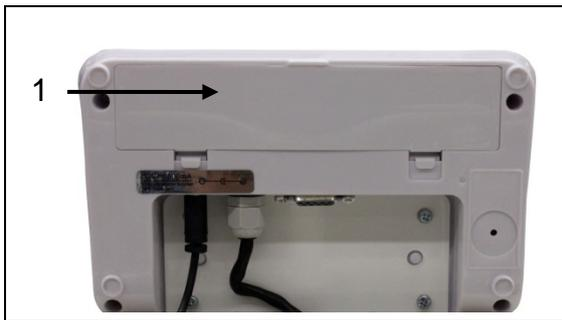
Akkufachdeckel (1) an der Unterseite des Anzeigeräters öffnen und Akku anschließen. Der Akku sollte vor der ersten Benutzung mindestens 12 Stunden geladen werden.
