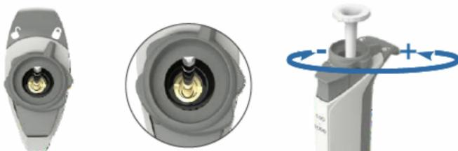
5. Drehen Sie das Kalibrierwerkzeug gegen den Uhrzeigersinn um das Volumen zu vergrößern und gegen den Uhrzeigersinn um es zu verkleinern.
