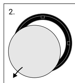
Entnimm die alte Membran aus dem Verschlussring.
