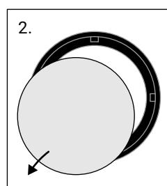
Retire l'ancienne membrane du bague de verrouillage.
