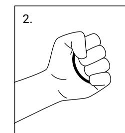
Nimm einen passenden Ring und drücke ihn ein paarmal in der Handfläche zusammen. Durch die Bewegung und die Wärme wird der Ring flexibler und die Montage einfacher.
