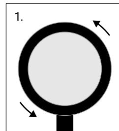
Löse den Ring, indem du ihn gegen die Uhrzeigerrichtung drehst.
