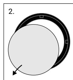
Retire la antigua membrana del anillo de fijación.
