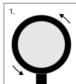
Ontgrendel de borgring van je stethoscoop door deze tegen de klok mee te draaien.
