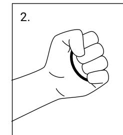
Neem een passende ring en druk deze een paar keer samen in de palm van je hand. De beweging en warmte maken de ring flexibeler en gemakkelijker te monteren.
