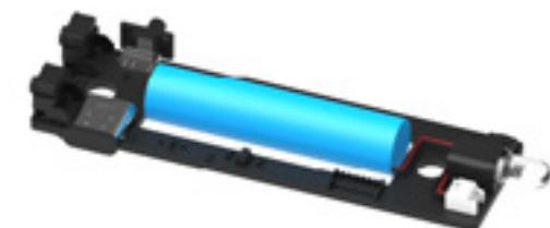
Se vuoi sostituire il mio LED, estrailo dalla scheda elettronica e inserisci il nuovo allo stesso modo. Il contatto più lungo è inserito nell'apertura a destra, come mostrato nell'illustrazione.
