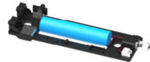
Willst du meine LED austauschen, ziehe sie aus der Leiterplatte heraus und setze die neue in gleicher Weise ein. Bitte beachte, dass der längere Kontakt, wie auf der Abbildung, in die rechte Öffnung gesteckt wird.
