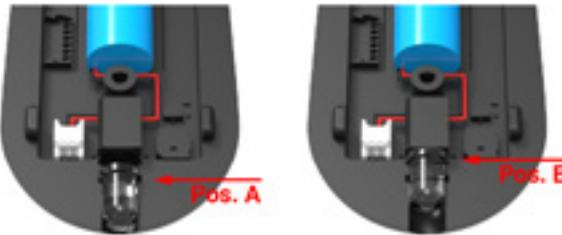
Für einen Batteriewechsel ziehe den Stecker aus dem Connector und stecke mit dem gleichen Prinzip eine neue Batterie ein.
