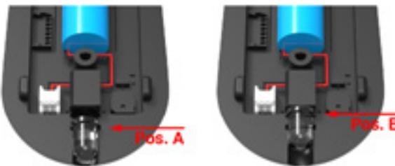
Para cambiar la batería, extraiga la clavija del conector e inserte una batería nueva siguiendo el mismo principio.
