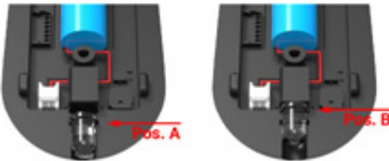
Per sostituire la batteria, scollega la spina dal connettore e inserisci una nuova batteria con lo stesso principio.
