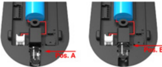
Voor het vervangen van de accu trek je de stekker uit de connector en steek je met hetzelfde principe een nieuwe accu in.
