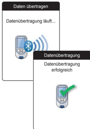
Nachdem die Verbindung hergestellt ist und der Download-Befehl gesendet wurde, zeigt das Gerät den Fortschritt der Datenübertragung an.
